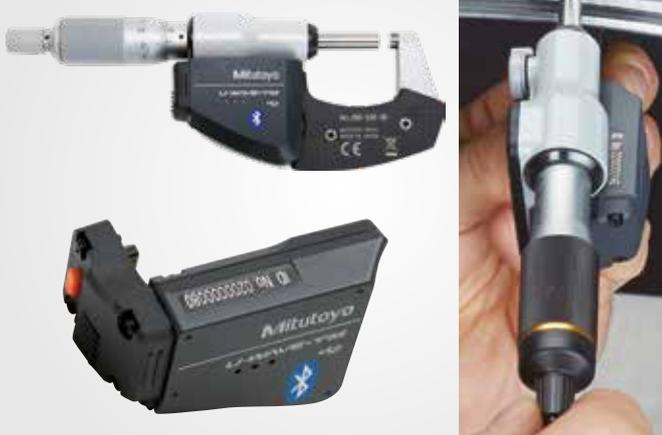
U-WAVE-TCB per calibri con unità di connessione
