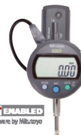
U-WAVE-T (trasmettitore) per strumenti di misura vari
