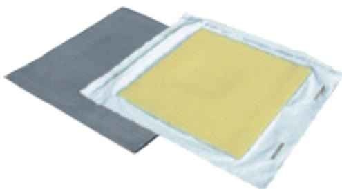
**Copritombino protettivo** in PU non assorbente e flessibile per tombini e grate adiacenti a canali di scolo o reti idriche, impedisce infiltrazioni di liquidi inquinanti assicurando tenuta sullo scarico. Resistente ad acqua, olio e molti agenti chimici. Colori disponibili: nero e giallo. Dimensione: 60x60
