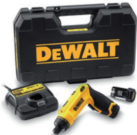
**Avvitatore giroscopico DCF608G2-QW**, con attacco inserti esagonale 1/4", tecnologia giroscopica in grado di azionare il prodotto in base al movimento del polso; massima coppia di serraggio 4Nm; velocità a vuoto 0-430 giri/min; illuminazione LED; peso 0.5 Kg; 2 batterie da 1.0Ah XR Litio 7.2V in dotazione; caricabatteria; fornito in valigetta
