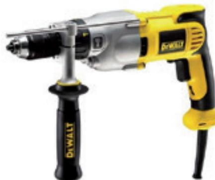
**Trapano con percussione DWD522KS-QS**, doppia velocità 0-1250/0-3500 giri/min; potenza assorbita 950W; potenza resa 415W; coppia di serraggio 40/20Nm; frizione meccanica di sicurezza; mandrino autoserrante 1.5-13mm; filetto alberino 1/2" x20 U.N.F.; peso 2.8Kg; impugnatura laterale orientabile; stop di profondità; valigetta
