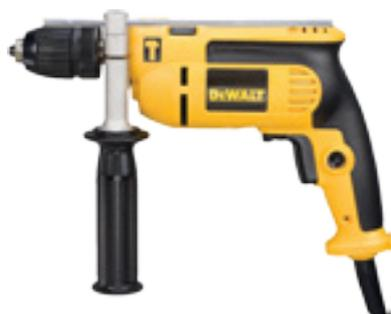
**Trapano con percussione DWD024KS-QS**, potenza 650 Watt; capacità mandrino 1.5-13 mm; autoserrante; velocità variabile; percussioni al minuto 0-47.600; peso 1.82 kg; capacità foratura max legno/acciaio/cemento: 25/13/16 mm; impugnatura in gomma; blocco dell'interruttore per lavorazioni continue; fornito in valigetta
