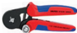
**Pinza per terminali a bussola**, con regolazione automatica per crimpaggio laterale, brunita, manici rivestiti in materiale bi-componente; crimpaggio facilitato del 20 %, minore ampiezza di presa ed ergonomia ottimizzata per serrare terminali a bussola secondo DIN 46228; pressatura a sezione quadra ora anche per terminali a bussola fino a 16 mm<sup>2</sup>, pressatura a sezione quadra per superfici ottimali indipendentemente dal posizionamento della connessione; lunghezza tot. 180mm
