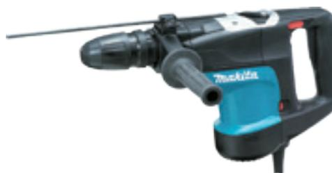
**Martello rotativo 40 mm**, potenza assorbita 800 W; 3 funzioni; limitatore di coppia; capacità foro punta T.C.T. cemento Ø 26 mm, corona diamantata cemento Ø 65 mm, legno Ø 32 mm, acciaio Ø 13 mm; velocità a vuoto 0÷1200 g/min; potenza colpo (normativa EPTA) 2.4 J; peso 2,8 kg., fornito in valigetta, con doppio mandrino
