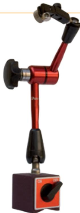
Supporto portacomparatore snodato magnetico, aste orientabili, bloccaggio centralizzato, regolazione micrometrica, base magnetica piana a "V" rettificata 60x50x55 mm., forza trazione 80 kg.
