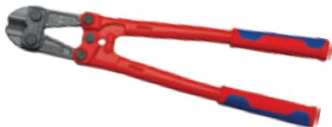
**Tagliabulloni** testa bonderizzata grigia intercambiabile, manici rivestiti in materiale bicomponente, capacità di taglio fino a 48 HRC, durezza taglianti 62 HRC ca., battuta forgiata con inserto in elastomero, manici a leva con angolazione ergonomica, 12 livelli di regolazione
