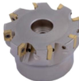
**Fresa per spallamento retto a 90° TA9016 con attacco a manicotto**, con fori di refrigerazione; adatta all'utilizzo di inserti APKT 1604...
