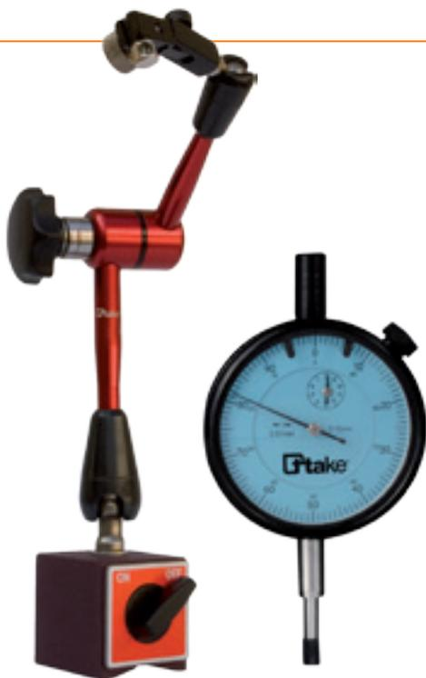
Kit supporto magnetico snodato porta comparatore (forza trazione 80 kg, raggio d'azione 340 mm), completo di comparatore di precisione ( $\varnothing$  58 mm, corsa 10 mm, risoluzione 0,01, scala circolare 0÷50÷100), con puntalino in ceramica
