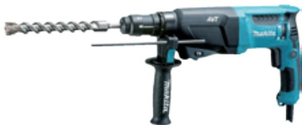
**Tassellatore elettrico**, potenza assorbita 1100 W; 2 funzioni; 12 regolazioni scalpello, limitatore di coppia; capacità foro punta T.C.T. cemento Ø 40 mm., corona cemento Ø 105 mm.; velocità a vuoto 235÷480 g/min; potenza colpo (normativa EPTA) 6,8 J; percussioni al minuto 1350÷2750; peso (normativa EPTA) 6,2 kg., fornito in valigetta
