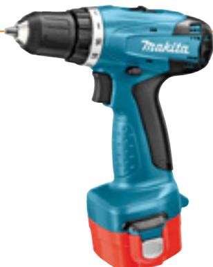
**Trapano avvitatore 12V**, NI-CD; 2,0 Ah; capacità foro: legno Ø 25 mm, metallo Ø 10 mm; velocità a vuoto l=0÷400 g/min, ll=0÷1300 g/min; coppia di serraggio: giunto elastico 18 Nm, giunto rigido 30 Nm; mandrino auto serrante Ø 10 mm; peso 1,5 kg. Accessori in dotazione: 2 batterie al Ni-CD 12V (2,0 Ah), carica batterie, inserto, valigetta
