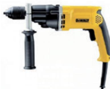
**Trapano rotativo D21441-QS**, doppia velocità 0-1100; potenza assorbita 770W; potenza resa 425W; 0-1100/0-2700 giri/min; coppia di serraggio 40/20Nm; frizione di sicurezza; mandrino autoserrante 1.5 - 13mm; filetto alberino 1/2" x 20 U.N.F.; peso 2,2Kg; impugnatura laterale orientabile; stop di profondità. Particolarmente indicato per utilizzo in carrozzerie, officine meccaniche, carpenterie metalliche
