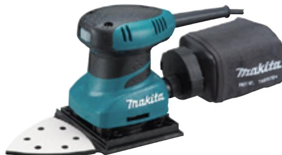
**Levigatrice orbitale 200V 200W**, con base delta velcrata e platorello triangolare; velocità 0-14000 orb/min; per superfici inaccessibili: angoli, cavità, persiane, etc.
