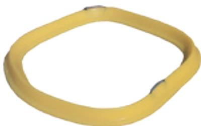
**Diga di sbarramento** in PU flessibile resistente ad acqua, olio e molti agenti chimici, aderisce a qualunque pavimentazione. Argina gli sversamenti e devia i liquidi impedendone l'immissione negli scarichi. Il profilo ad incastro consente di chiudere perfettamente a cerchio la diga, o di collegarne più tra di loro per coprire la superficie interessata. Dimensione: 8x10x300 (h/p/l)
