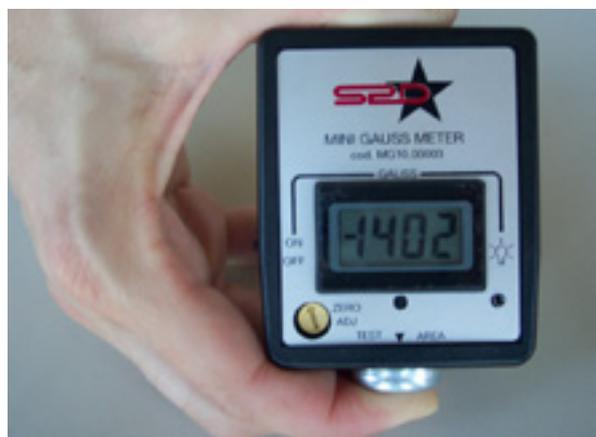
**Mini gaussmetro MG10**, strumento semplice e comodo per misurare il residuo magnetico presente in un pezzo d'acciaio. Misura digitale variabile da  $\pm 199,9$  gauss. Funzionamento: dopo aver acceso lo strumento, appoggiarlo sul pezzo metallico da controllare; sul display apparirà il valore del residuo magnetico espresso in gauss.
