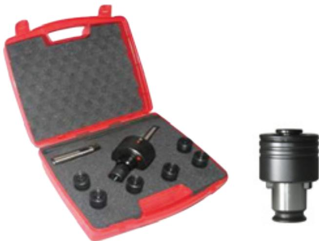
Kit in valigetta completo di un maschiatore ad inversione automatica con attacco cono morse 2 + 6 bussole con frizione BUF1, una per misura da M3 - M4 - M6 - M8 - M10 - M12 + una riduzione cono morse 3/2
