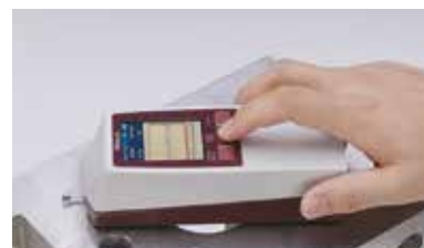
Il luminoso display LCD a colori ti guiderà facilmente attraverso il menu del Surftest.
