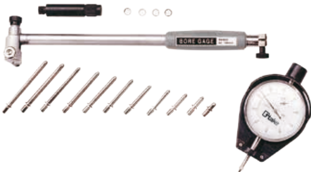
Alesmetro con comparatore , testina e punte di contatto in acciaio temprato, attacco comparatore Ø 8 mm, risoluzione 0,01
