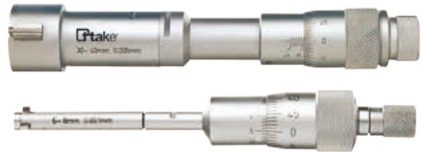
Micrometro per interni a tre punte , fornito con anelli e prolunga, tamburo graduato con frizione sensitiva, risoluzione fino a 12 mm: 0,001 mm; oltre 12 mm: 0,005 mm.
